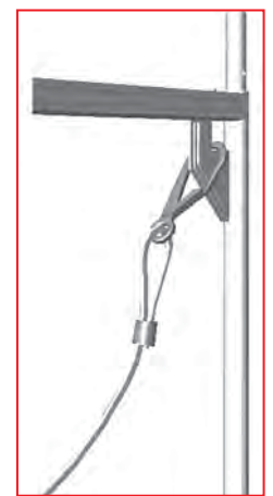
Fig. 3.3 - Fästning i vinkelplåt
